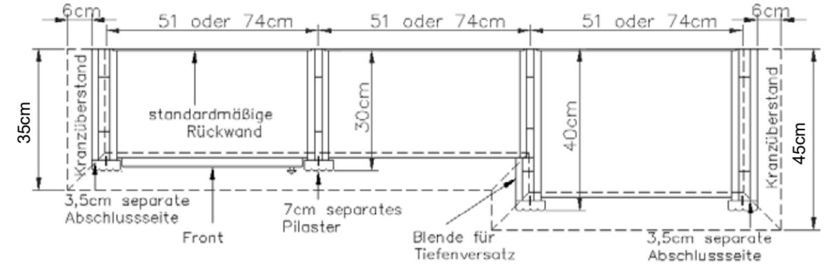
Für die Höhen 3 bis 8 Raster werden die jeweiligen Möbel mit einer Deckplatte geliefert, die einen seitlichen Überstand von jeweils 5 cm hat. Bei den Höhen 10 und 12 Raster werden Kränze geliefert, die einen seitlichen Überstand von jeweils 6 cm haben. Alle Abmessungen entnehmen Sie der oben stehenden Skizze. Bitte bedenken Sie dies bei Ihren Planungen!
