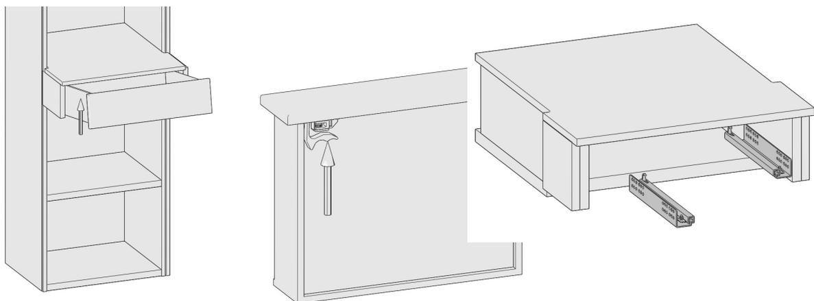
Entnehmen Sie zuerst den Schubkasten. Ziehen Sie den Schubkasten heraus. Heben Sie dann den Schubkasten vorne aus und drücken Sie dabei die Schnäpper. Schrauben Sie nun die linke Schubkastenschiene ab.
