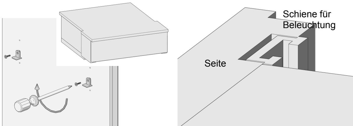
Auspacken der Buchablage nach Verpackungsnummer laut Zeichnung. Da die Schiene der Glaskantenbeleuchtung zu der Schrankseite übersteht, muss die passgenaue Buchablage vor dem Einbau demontiert werden.
