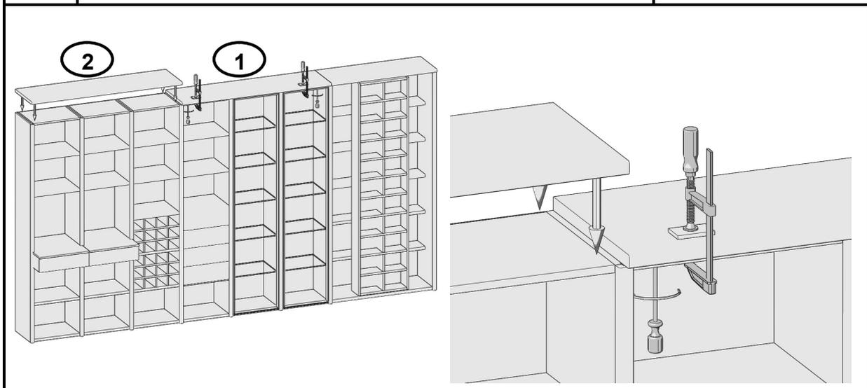
Bei mehreren Deckplatten beginnen Sie mit der Montage in der Mitte (1). So können Toleranzen nach außen ausgeglichen werden. Legen Sie die Platten mittig auf den Schrank und verschrauben Sie diese von unten durch den Oberboden mit den Schrauben 3,5 x 30mm. Legen Sie nun die restlichen Platten links bzw. rechts auf den Schrank (2).
