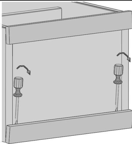
Legen Sie den Korpus auf die Rückwand und lösen Sie die Schonleisten, indem Sie mit einem Schlitzschraubendreher von der Bodenmitte her hinter die Leisten fahren und den Schraubendreher vom Boden wegziehen. Setzen Sie bei größer werdendem Spalt den Schraubendreher nach.
