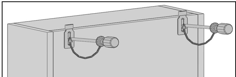
Lösen Sie die Schrauben des Führungsteils an der Rückwand des Schieberegals (1). Schieben Sie danach die Führungsteile in die Führungsschiene in der Deckplatte (2) und ziehen Sie die Schrauben anschließend wieder fest (3).
