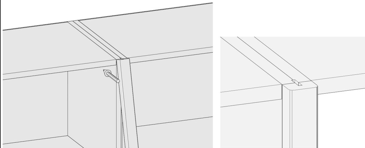
Nun können Sie das Profil in die Nut zwischen den beiden Schrankseiten stecken. Beginnen Sie dabei von oben und halten es mit den Schrankseiten bündig. Drücken Sie es nun mit gleichmäßigem Druck von oben nach unten in die Nut.
